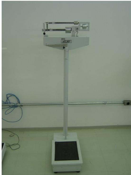
A Balança Mecânica Welmy 110ch tem capacidade de 150kg e divisões de 100 gramas.
